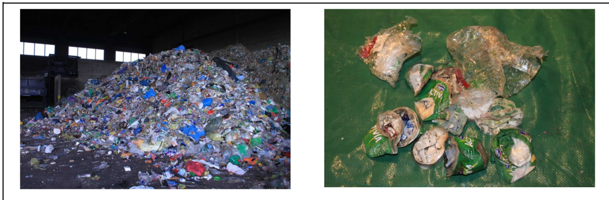
Abb. 2: links: LVP-Ausgangsmaterial (ca. 25,52 Mg) im Bunker und Aufgabe mittels Radlader/ rechts: aussortierte PLA-haltige Materialien
